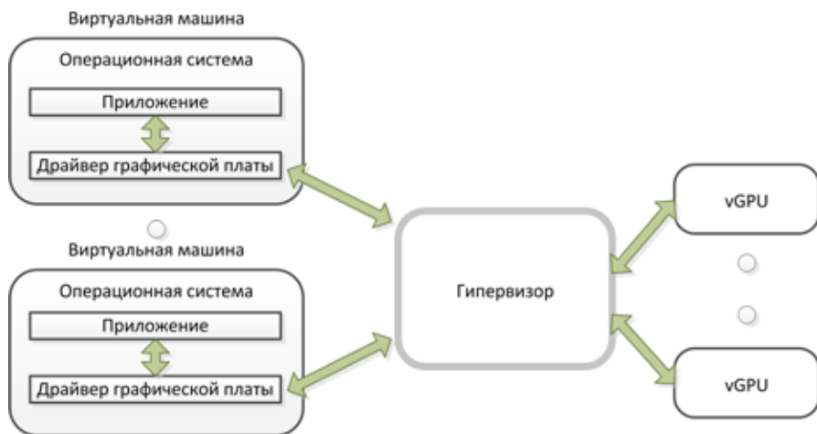
Рис. 2. Схема взаимодействия виртуальных машин и виртуальных графических плат
