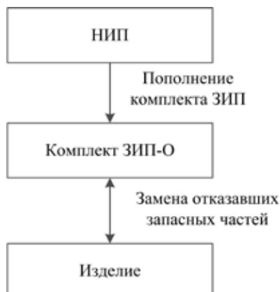
Рис. 1. Типовая структура использования комплекта ЗИП-О
